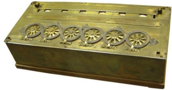
Figure 2 Pascaline, première machine à calculer
