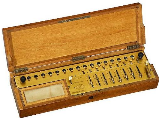
Figure 3 Arithmomètre (calculateur avec clavier)
